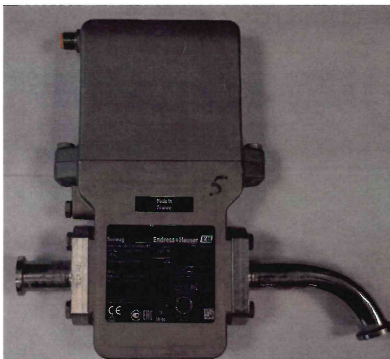
Рисунок 1.1 – Фотография общего вида расходомера электромагнитного Dosimag № T6202719000
