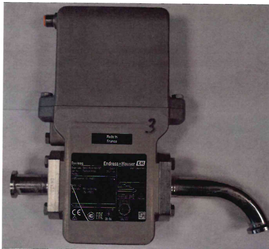
Рисунок 1.1 – Фотография общего вида расходомера электромагнитного Dosimag № T6202A19000
