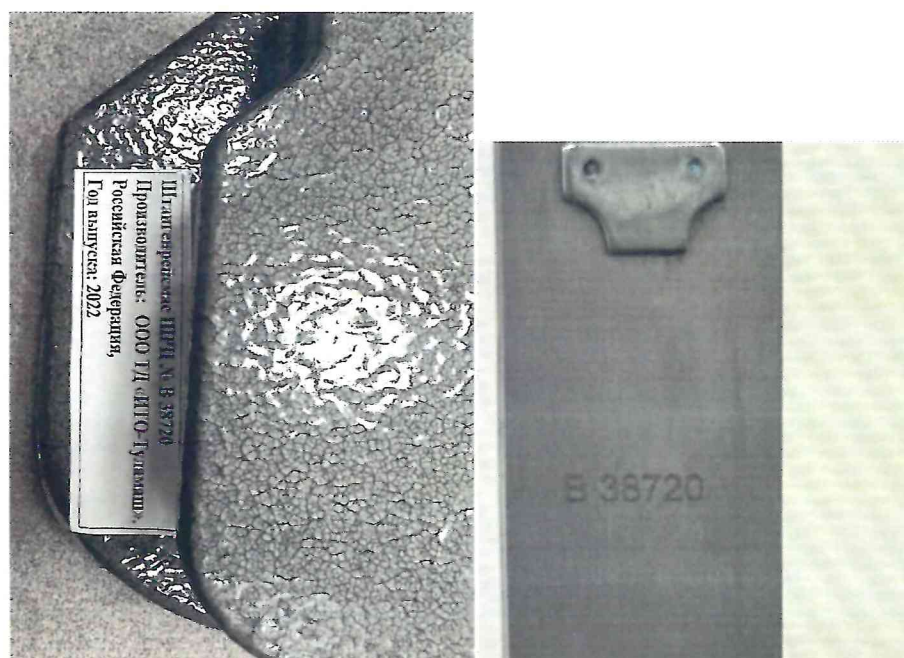
Рисунок 1.2 – Фотографии маркировки штангенрейсмаса ШРЦ № В 38720
