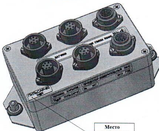
Рисунок А.3 – Место нанесения наклейки предприятия изготовителя на разрушающей основе для защиты от несанкционированного доступа, настройки и вмешательства
