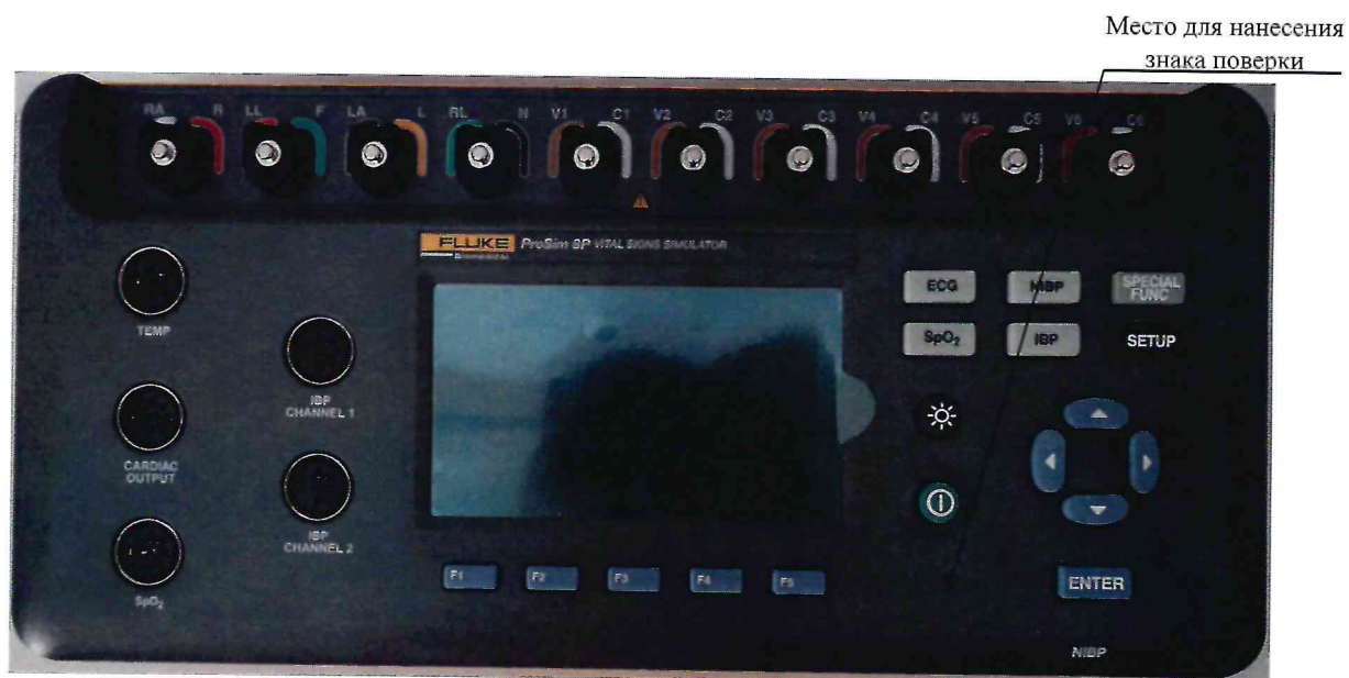
Рисунок 2.1 – Схема (рисунок) с указанием места для нанесения знака поверки на генератора сигналов пациента Fluke ProSim 8 № 6955023
