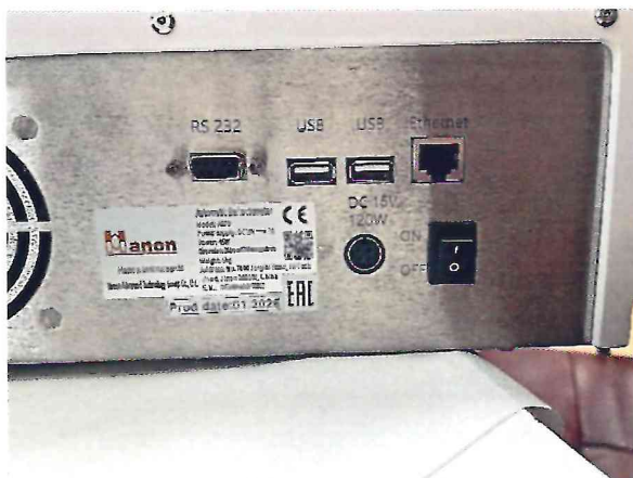
Рисунок 1.2 – Фотография маркировки рефрактометра автоматического А670 № OG3404A30270017
