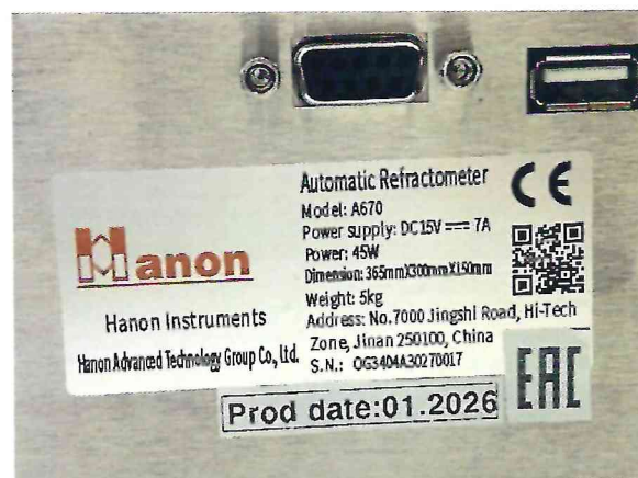
Рисунок 1.2 – Фотография маркировки рефрактометра автоматического А670 № OG3404A30270017
