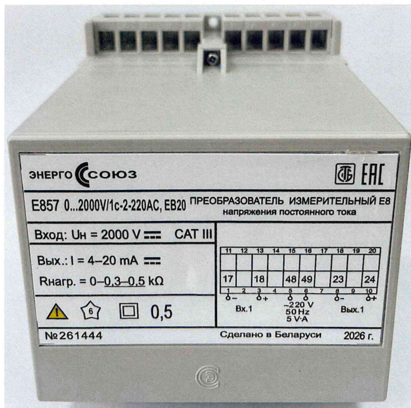
Рисунок 1.12 – Фотография модификации E857 в корпусе EB20 (информация на табличке носит иллюстративный характер)
