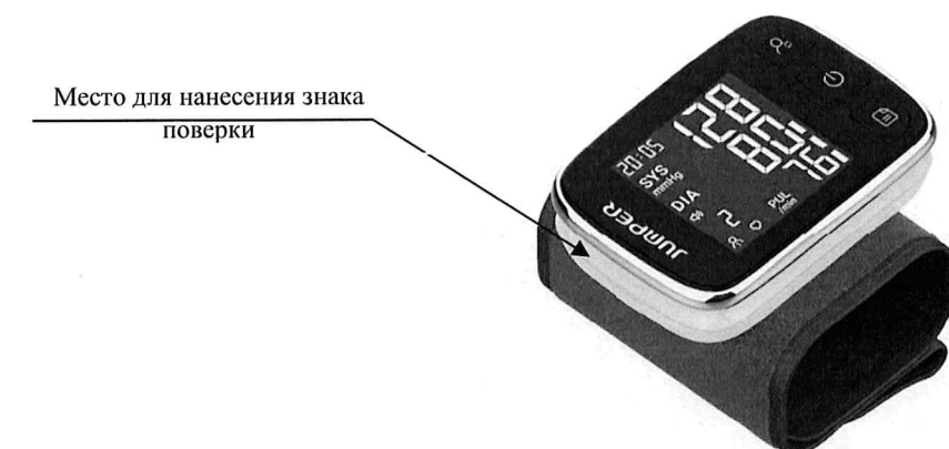
Рисунок 2.3 – Схема (рисунок) с указанием места для нанесения знака поверки измерителей артериального давления автоматических с принадлежностями: приборы для измерения артериального давления и частоты пульса цифровые HWA20
