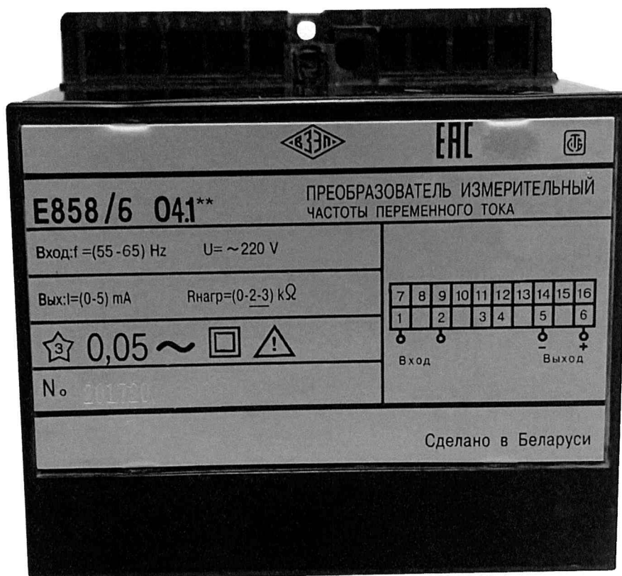
Рисунок 6 – Общий вид и маркировка ИП E858/6 O4.1** для поставки на экспорт в общеклиматическом исполнении O4.1**
