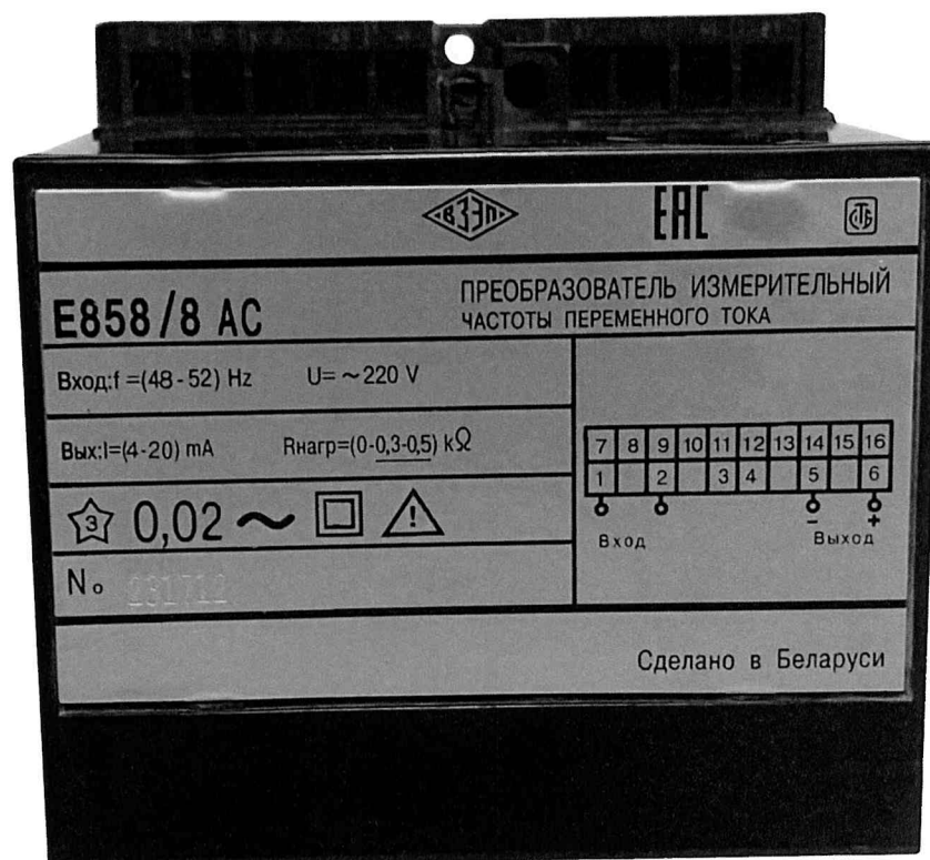
Рисунок 8 – Общий вид и маркировка ИП E858/8 AC для поставки на атомные станции
