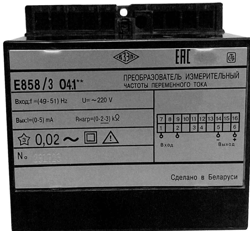
Рисунок 4 – Общий вид и маркировка ИП E858/3 04.1** для поставки на экспорт в общеклиматическом исполнении 04.1**
