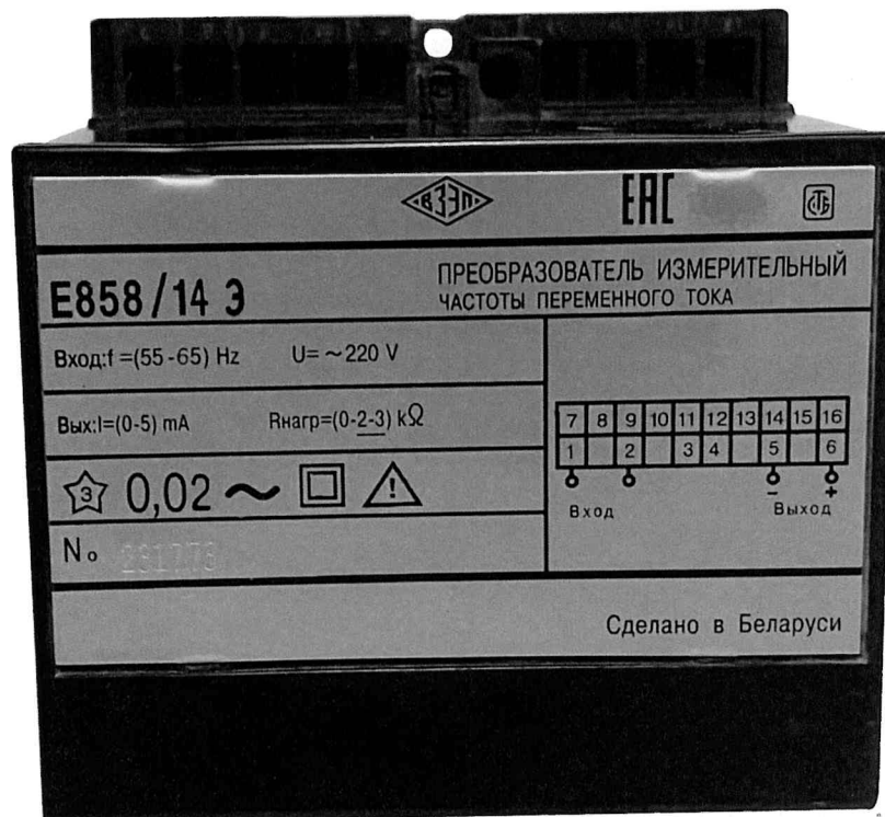
Рисунок 14 – Общий вид и маркировка ИП E858/14 Э для поставки на экспорт в страны с умеренным климатом
