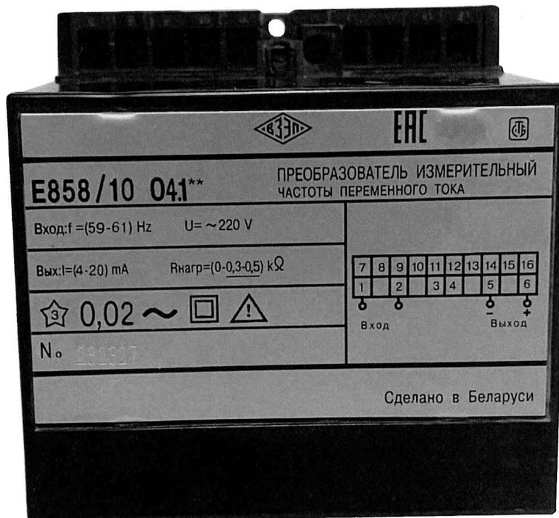
Рисунок 10 – Общий вид и маркировка ИП E858/10 04.1** для поставки на экспорт в общеклиматическом исполнении 04.1**
