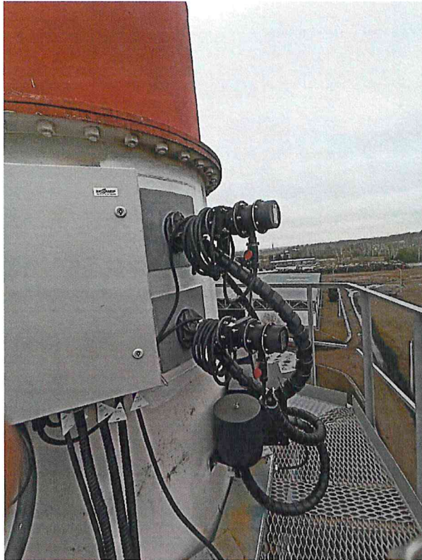
а) измеритель расхода и скорости газового потока ИС-14.М
