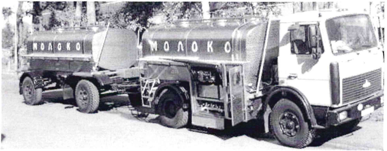
Рисунок 1 – Внешний вид автомолокоцистерны СМА 9 с расходомерным устройством PD-340
