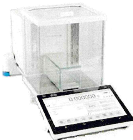
Рисунок 1.5 – Фотография общего вида весов лабораторных электронных ХА с индексами «Y», «A», «S» в обозначении модификации (изображение носит иллюстративный характер)
