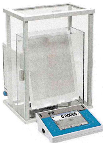
Рисунок 1.8 – Фотография общего вида весов лабораторных электронных ХА с индексами «4Y», «F» в обозначении модификации (изображение носит иллюстративный характер)
