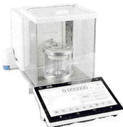
Рисунок 1.7 – Фотография общего вида весов лабораторных электронных ХА с индексами «Y», «A», «P» в обозначении модификации (изображение носит иллюстративный характер)
