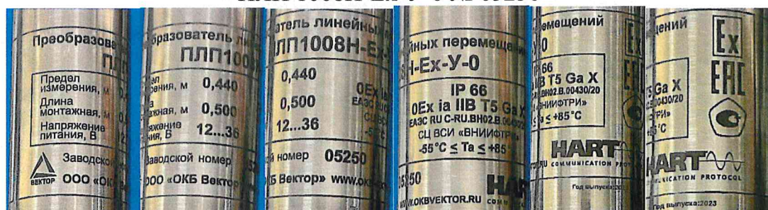
Рисунок 1.1 – Фотография общего вида преобразователя линейных перемещений ПЛП 1008Н-Ех-У-0 № 05250
