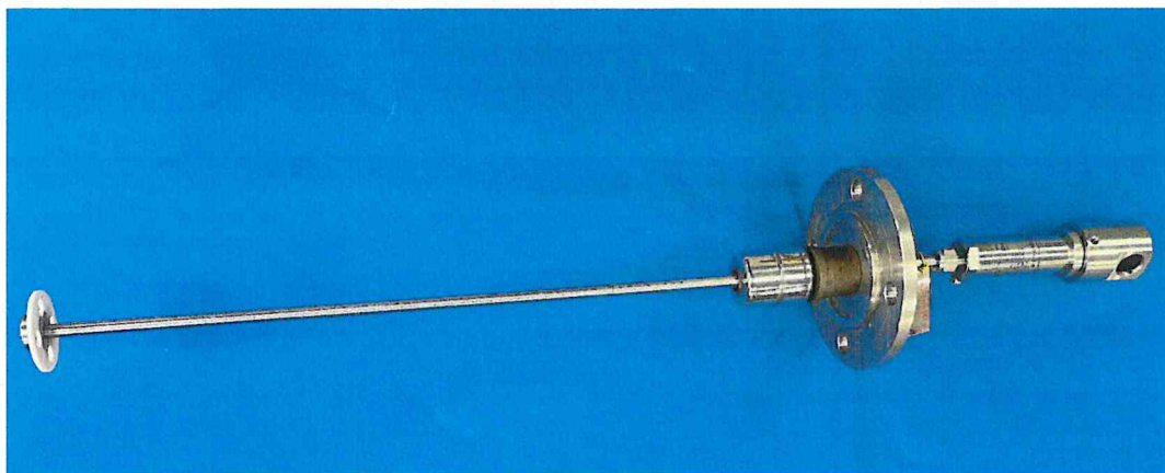
Рисунок 1.1 – Фотография общего вида преобразователя линейных перемещений ПЛП 1008Н-Ех-У-0 № 05250
