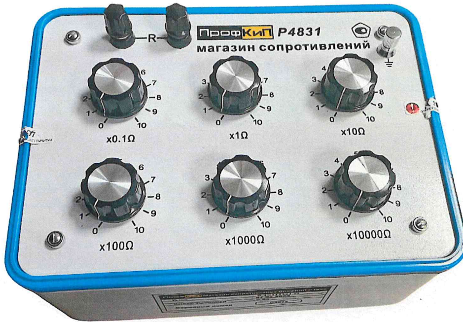
Рисунок 1.1 – Фотография общего вида магазина сопротивлений ПрофКип Р4831 № С3012
