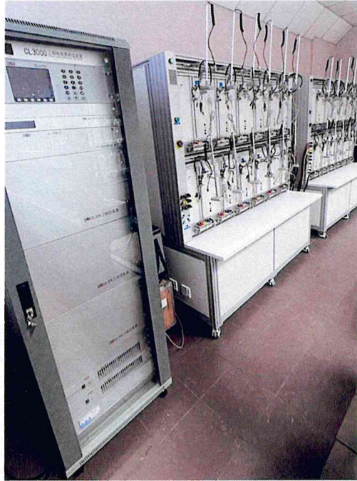
Рисунок 1.1 – Фотография общего вида установки для поверки счётчиков электрической энергии CL30005-24 № 09176
