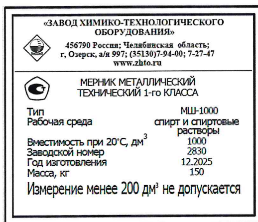
Рисунок 1.2 – Фотография маркировки мерника металлического технического 1-го класса МШ-1000 № 2830
