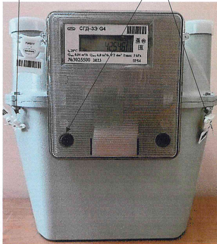
Рисунок 3.1 – Схема пломбировки от несанкционированного доступа
