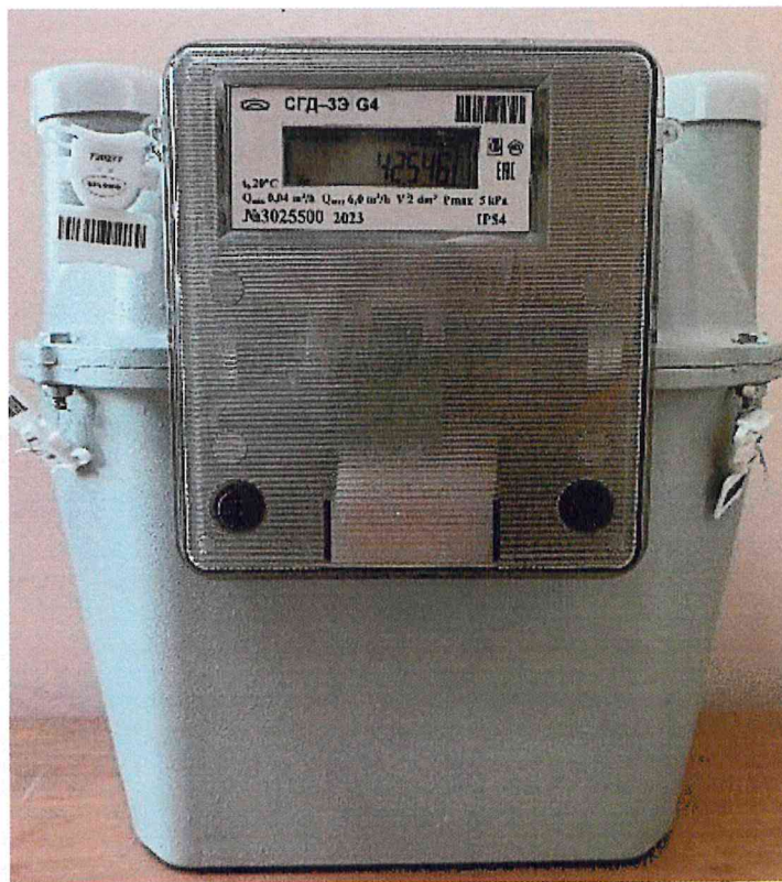
Рисунок 1.1 – Фотографии общего вида счетчиков газа диафрагменных с электронным компенсатором СГД-3Э (изображение носит иллюстративный характер)
