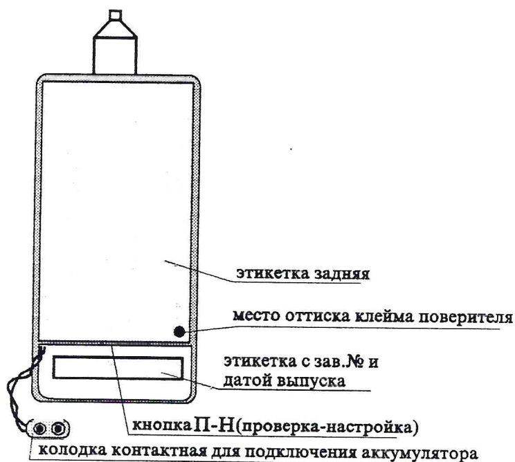
Рис. 1. Вид прибора «АЛКОТЕСТ-203» сзади со снятой крышкой отсека питания.
