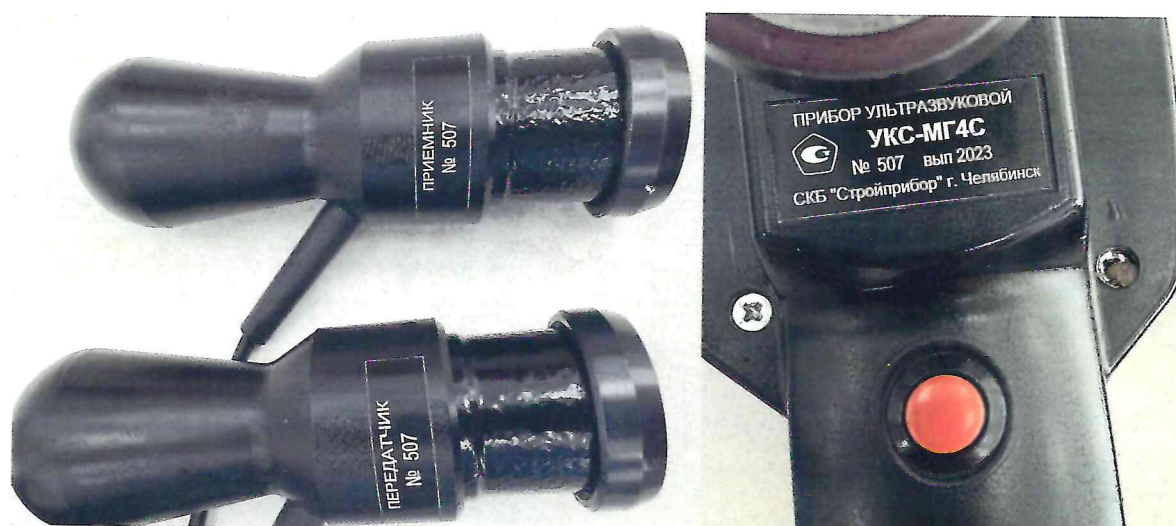
Рисунок 1.1 – Фотографии общего вида и маркировки прибора ультразвукового УКС-МГ4С № 507 в составе – электронный блок (измеритель ультразвуковой) и преобразователи ультразвуковые (передатчик № 507, приемник № 507)
