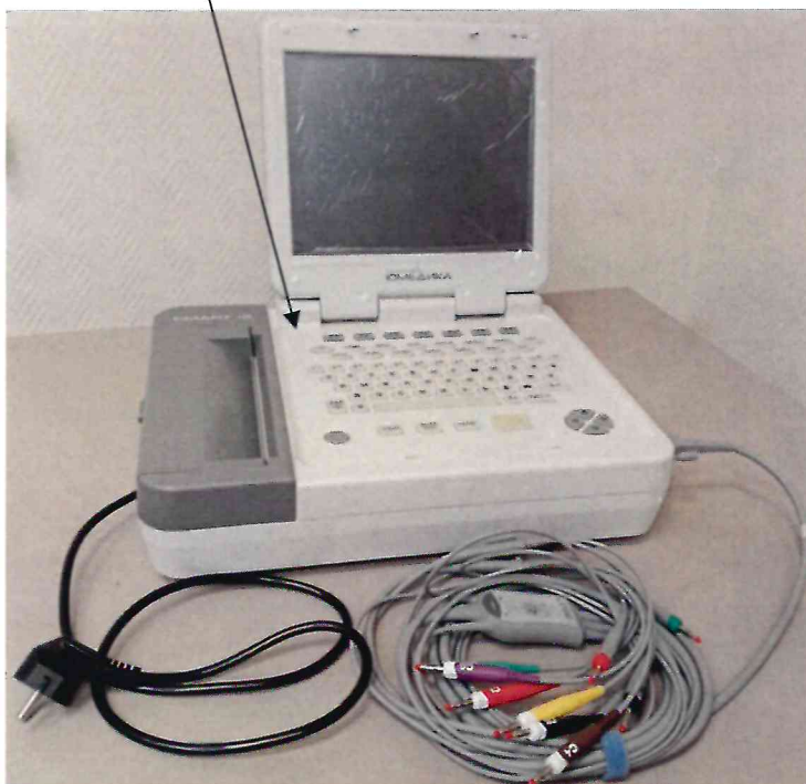
Рисунок 2.4 – Схема (рисунок) с указанием места для нанесения знака поверки для электрокардиографа СМАРТ 12 Экспресс
