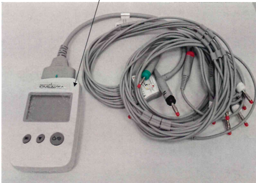
Рисунок 2.5 – Схема (рисунок) с указанием места для нанесения знака поверки для электрокардиографа СМАРТ 1010
