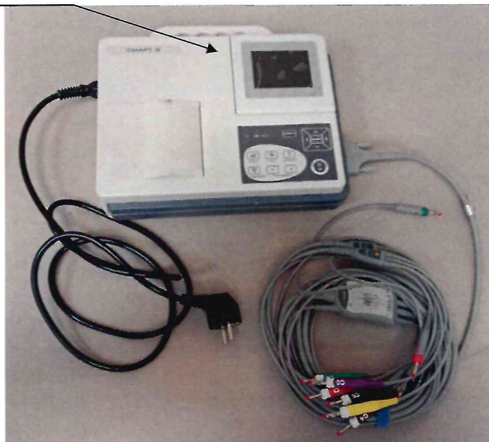
Рисунок 2.2 – Схема (рисунок) с указанием места для нанесения знака поверки для электрокардиографа СМАРТ 3В
