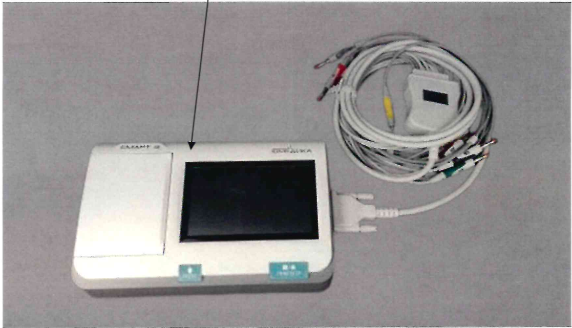
Рисунок 2.1 – Схема (рисунок) с указанием места для нанесения знака поверки для электрокардиографа СМАРТ 3А
