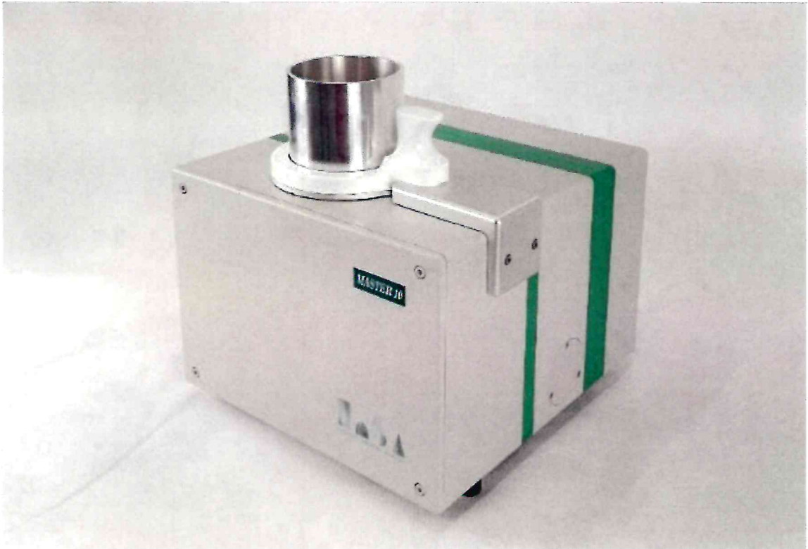
Рисунок 1.1 – Фотография общего вида ИК-Фурье спектрометра MASTER10-S № NSN250073
