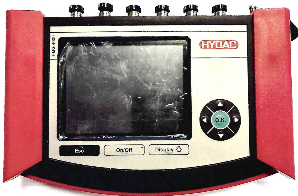
Рисунок 1.4– Фотография регистратора данных портативного HMG 4000-000 системы
