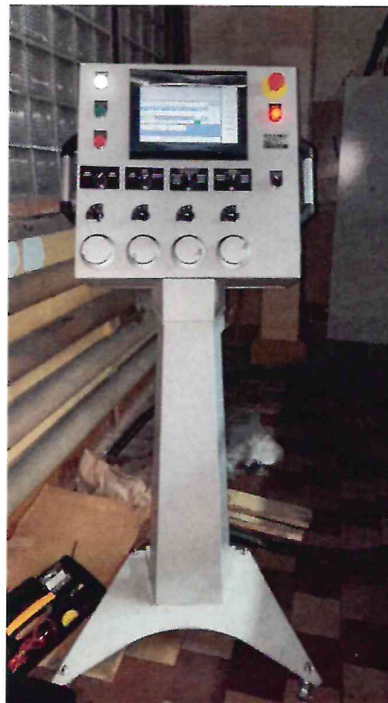
Рисунок 1.3 – Фотография пульта управления ИФДС5518-80.20.00.000 системы
