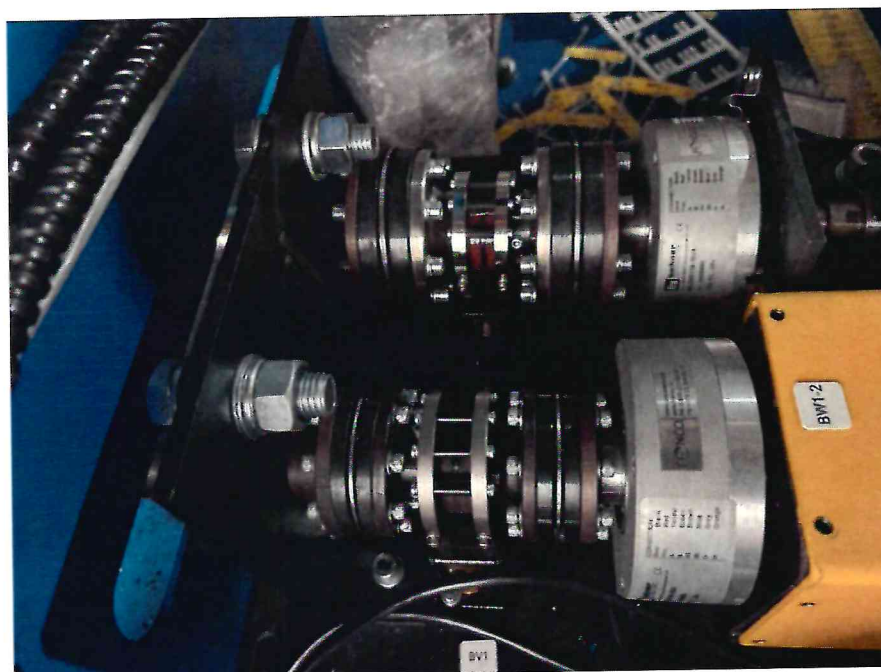
Рисунок 1.7 – Фотография общего вида инкрементальных энкодеров 80-230110-1024
