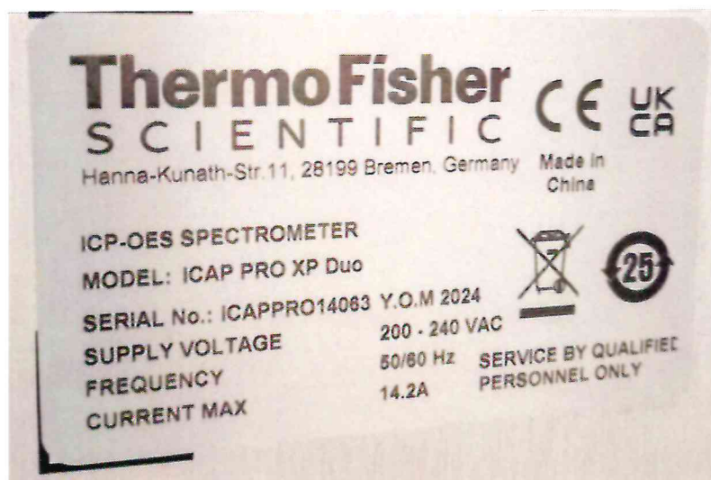
Рисунок 1.2 – Фотография маркировки спектрометра эмиссионного с индуктивно-связанной плазмой iCAP PRO XP Duo № iCAPPRO14063
