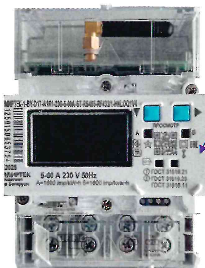
Рисунок 2.4 – Схема (рисунок) с указанием места для нанесения знака поверки на счетчики «МИРТЕК-1-ВУ»
