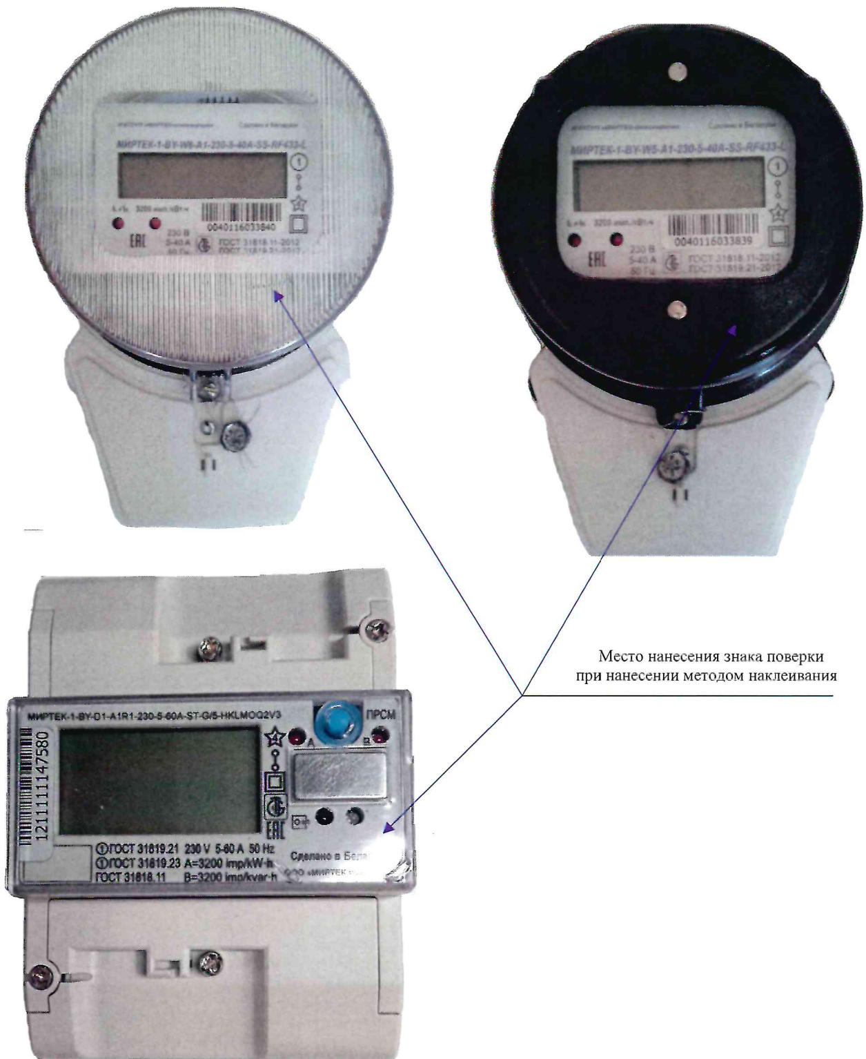
Рисунок 2.2 – Схема (рисунок) с указанием места для нанесения знаков поверки на счетчики «МИРТЕК-1-ВУ»
