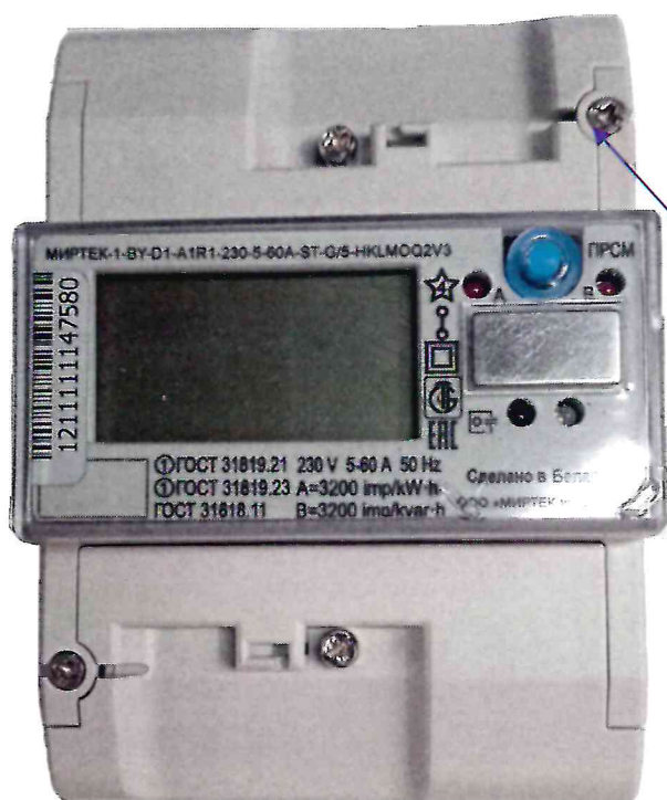
Рисунок 3.2 – Схема пломбировки счетчиков от несанкционированного доступа
