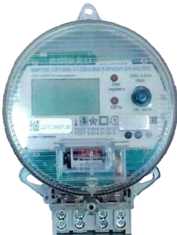
Рисунок 1.11 – Фотография общего вида счетчика «МИРТЕК-1-ВУ» в типе корпуса W6 с исполнением ЖКИ № 2 (изображение носит иллюстративный характер)
