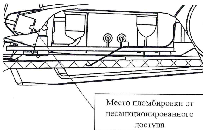
Рисунок 3.1 – Схема пломбировки от несанкционированного доступа
