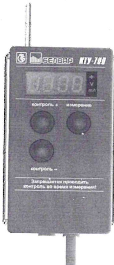
Рисунок 1 – Общий вид измерителя тока утечки ИТУ-700
