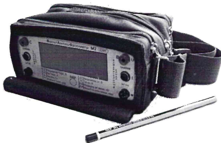
Рисунок 1 – Внешний вид вольтамперфазометра М2.
