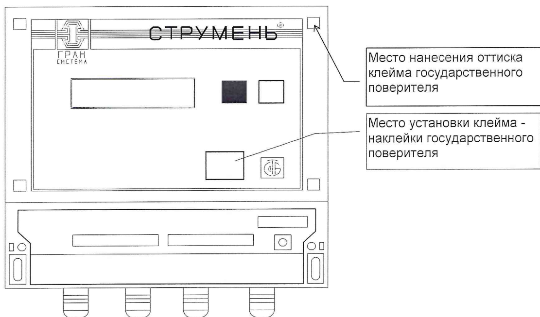
Рисунок А.1 - Место установки пломбы для нанесения оттиска клейма государственного поверителя на электронном модуле УЗР
