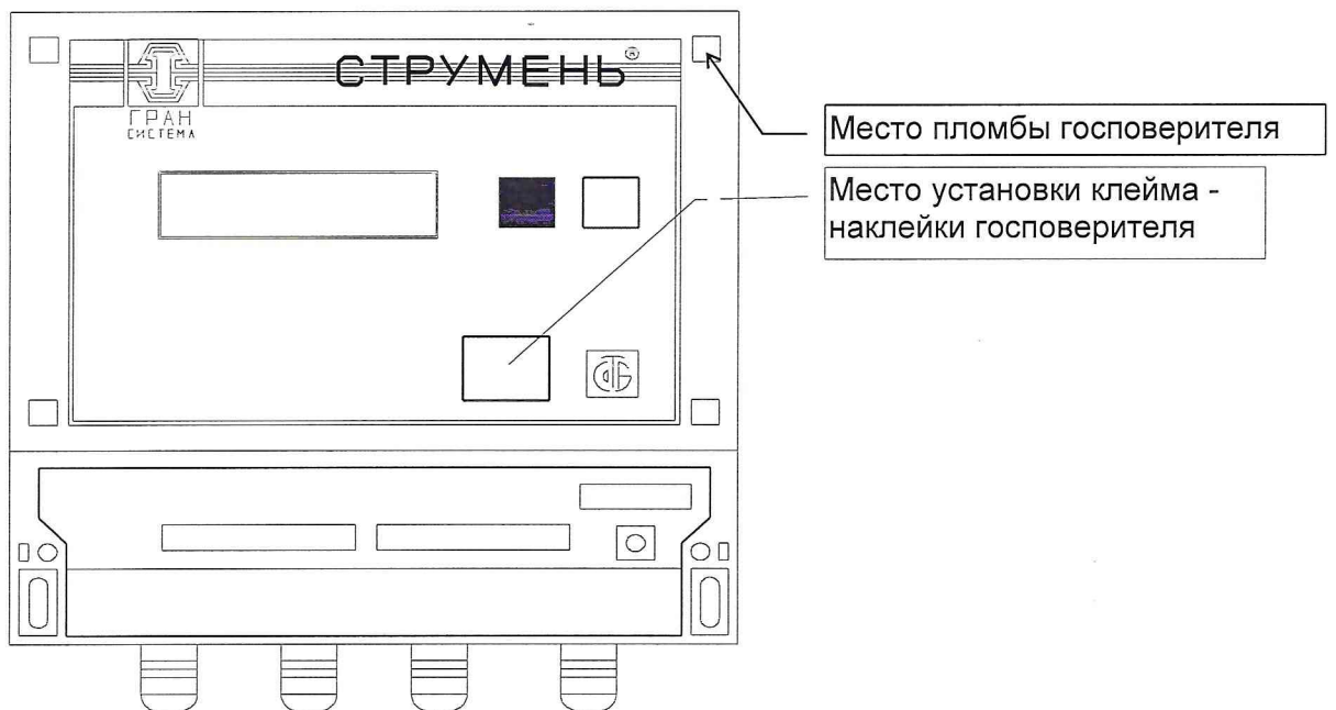
Рисунок А.1 - Место установки пломбы госповерителя на электронном модуле УЗР Рисунок А.2 - Место установки клейма-наклейки и пломбы госповерителя на ТВ
