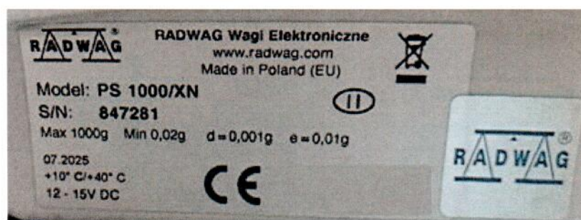
Рисунок 1.4 – Маркировка весов лабораторных (изображение носит иллюстративный характер)
