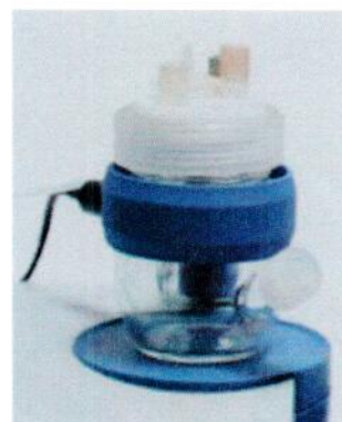
Рисунок 1.3 – Фотография общего вида ячейки для волюмометрического титрования
