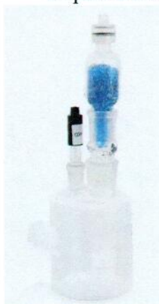
Рисунок 1.2 – Фотография общего вида ячейки для кулонометрического титрования
