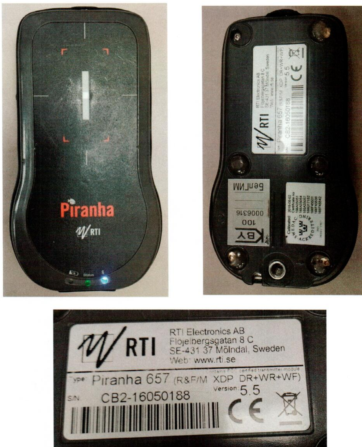
Рисунок 1.1 – Фотографии общего вида и маркировки дозиметра
