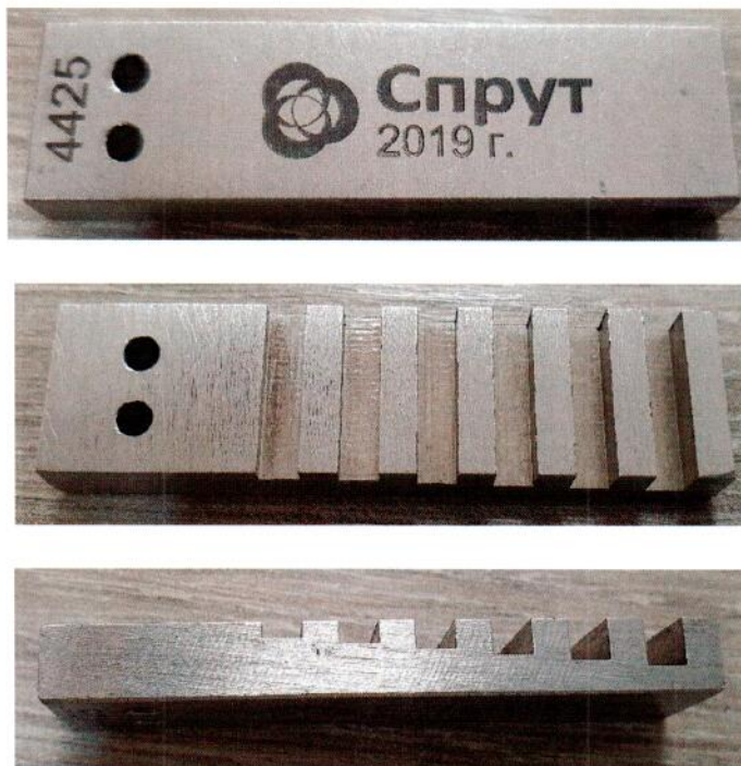
Рисунок 1.1 – Общий вид и маркировка эталона чувствительности канавочного «Спрут» № 4425
