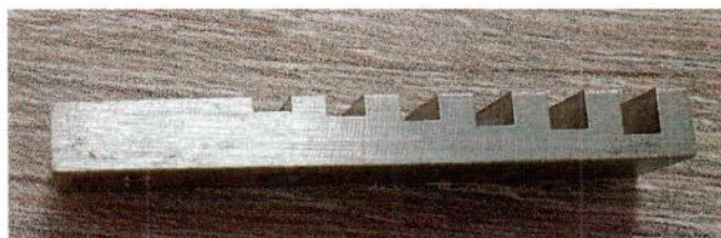
Рисунок 1.1 – Общий вид и маркировка эталона чувствительности канавочного «Спрут» № 4426
