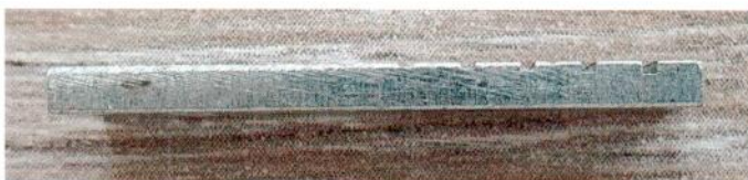
Рисунок 1.1 – Общий вид и маркировка эталона чувствительности канавочного «Спрут» № 1789
