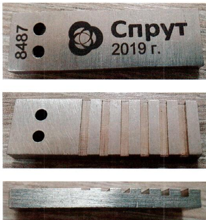
Рисунок 1.1 – Общий вид и маркировка эталона чувствительности канавочного «Спрут» № 8487
