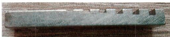
Рисунок 1.1 – Общий вид и маркировка эталоны чувствительности канавочного «Спрут» № 8376
