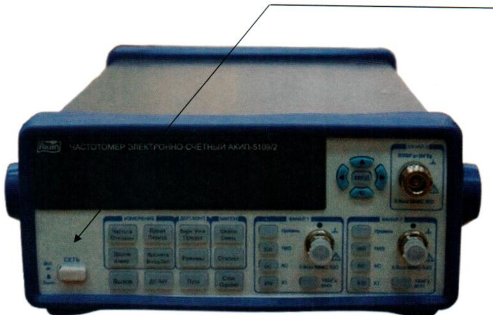
Рисунок 2.1 – Схема (рисунок) с указанием места для нанесения знака поверки средств измерений
