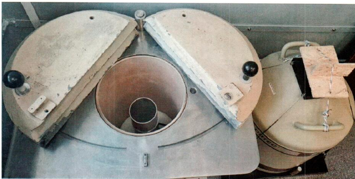
а) внешний вид сосуда Дьюара и детектора с криостатом из состава блока детектирования спектрометра
