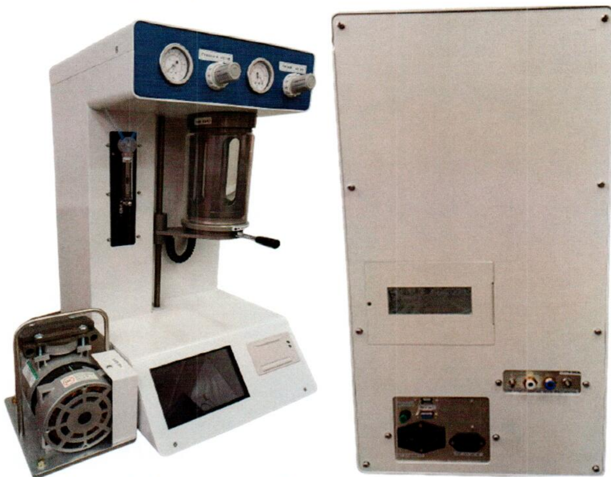
Рисунок 1.1 – Фотографии общего вида счетчика частиц в масле HK-L02A № 2410ZAA0039
