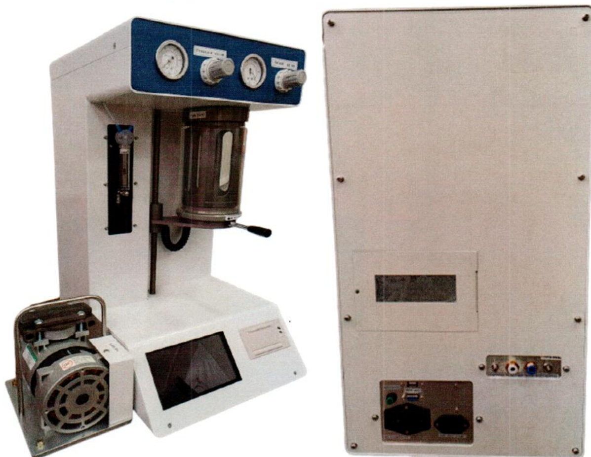
Рисунок 1.1 – Фотографии общего вида счетчика частиц в масле HK-L02A № 2411ZAA0048
