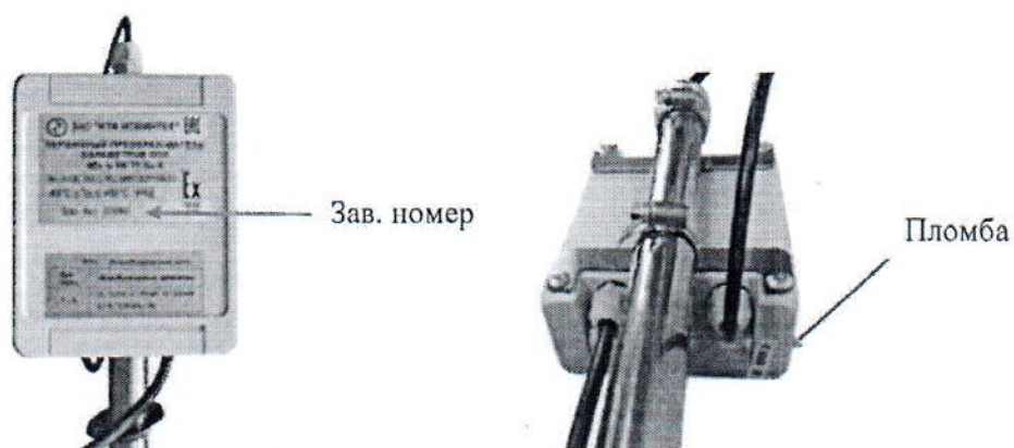
Рисунок 15 – Внешний вид ППП (контроллер без клеммного отсека)
