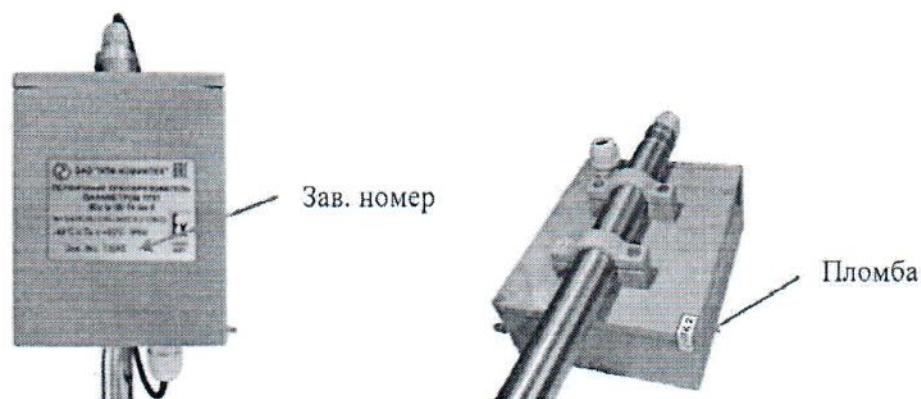
Рисунок 14 – Внешний вид ППП (контроллер с клеммным отсеком)
