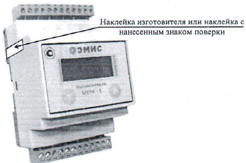
Рисунок 4 - Схема пломбировки вычислителя счетчиков раздельного исполнения
