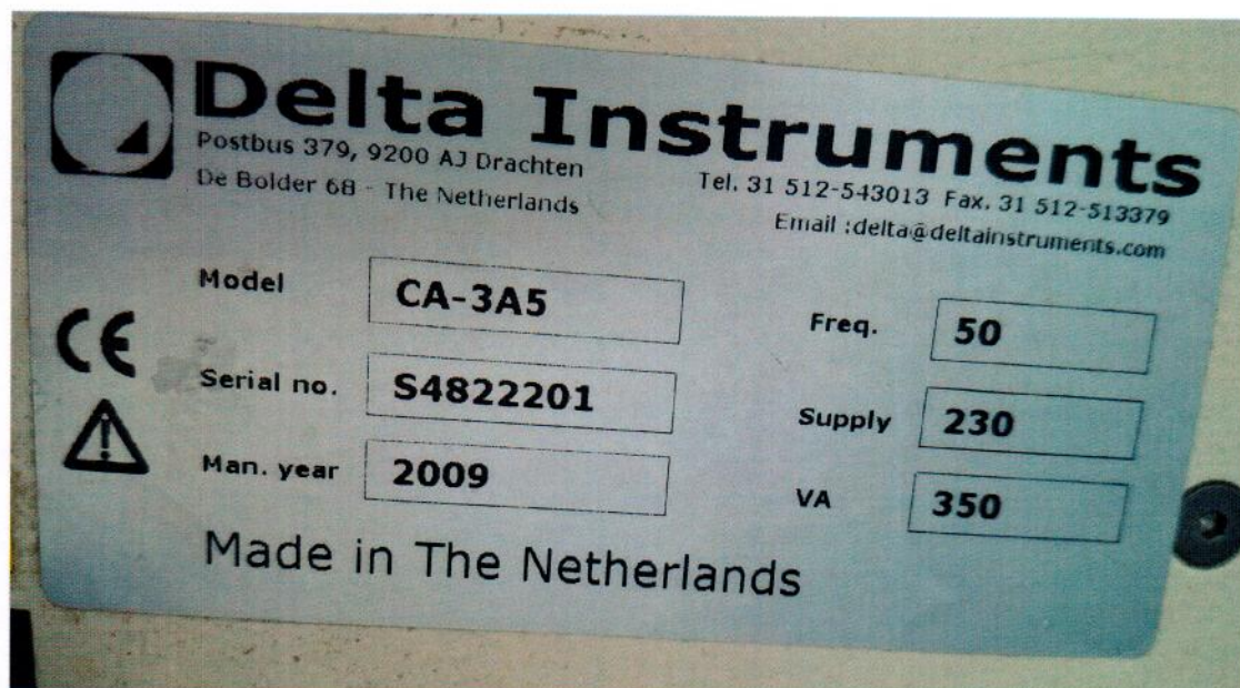
Рисунок 1.2 – Фотография маркировки анализатора количества клеток SomaScope MKII модель CA-3A5 № S4822201
