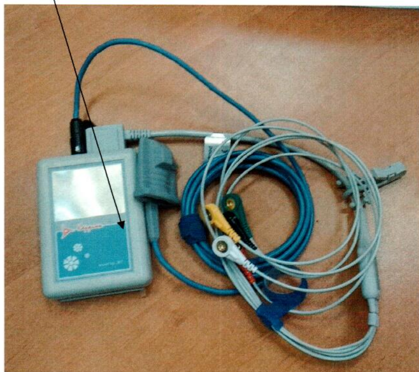
Рисунок 2.3 – Схема (рисунок) с указанием места для нанесения знака поверки на системы длительного мониторинга электрокардиограмм и артериального давления «КАРДИАН-СДМ»: «КАРДИАН ЭКГ»
