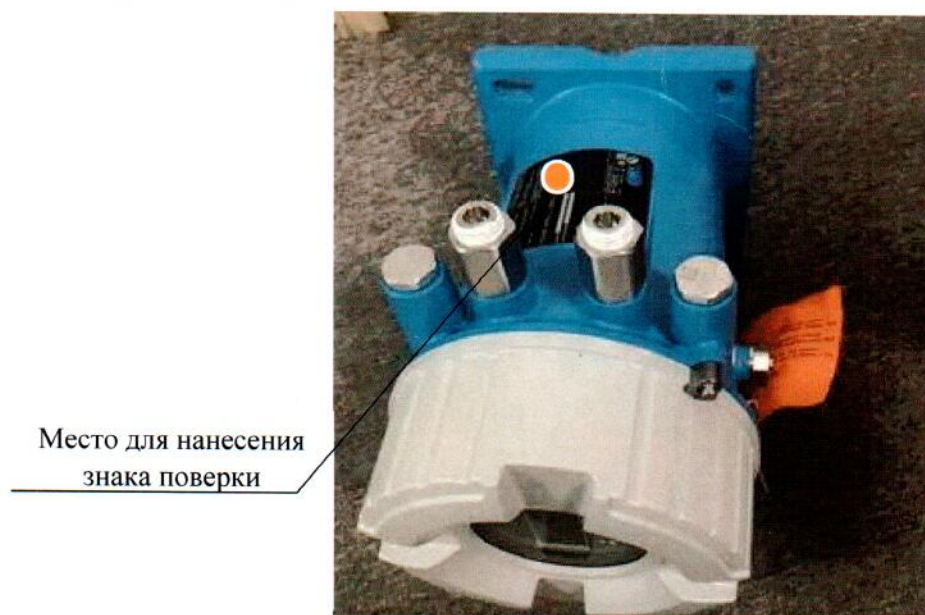
Рисунок 2.1 – Схема (рисунок) с указанием места для нанесения знака поверки средств измерений на устройство связи
