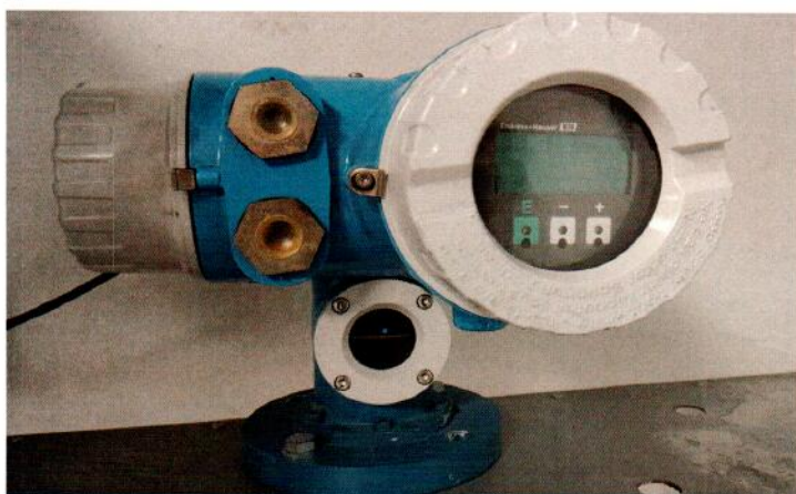
Рисунок 1.4 – Внешний вид и образец маркировки уровнемера Proservo из состава системы (изображения носят иллюстративный характер)
