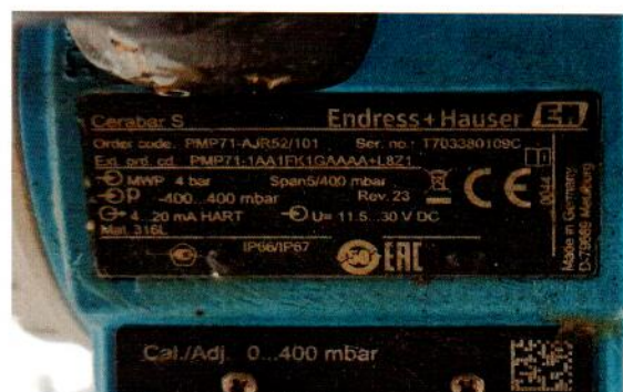
Рисунок 1.7 – Внешний вид и образец маркировки преобразователя давления паров из состава системы (изображения носят иллюстративный характер)
