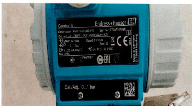
Рисунок 1.6 – Внешний вид и образец маркировки преобразователя гидростатического давления из состава системы (изображения носят иллюстративный характер)
