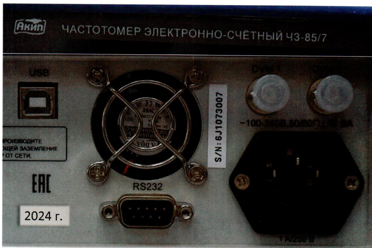
Рисунок 1.2 – Маркировка частотомера электронно-счетного ЧЗ-85/7 с опцией 101 № 6J1073007
