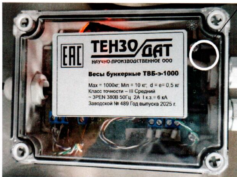
Рисунок 2.1 - Фотография с указанием места нанесения знака поверки (наклейки) на корпус ПТН весов бункерных ТВБ-э-1000 № 489
