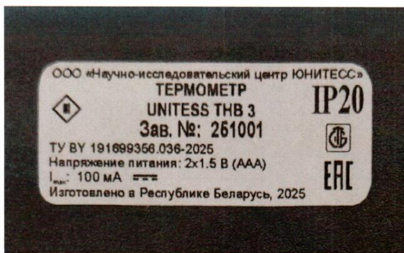
Рисунок 1.2 – Маркировка термометров UNITESS THB 3 (изображения носят иллюстративный характер)
