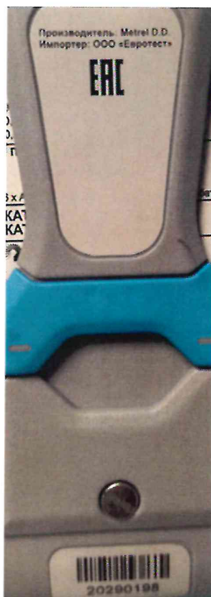
Рисунок 1.2 – Маркировка измерителя полного сопротивления линии, контура и параметров УЗО MI 3122 № 20290198
