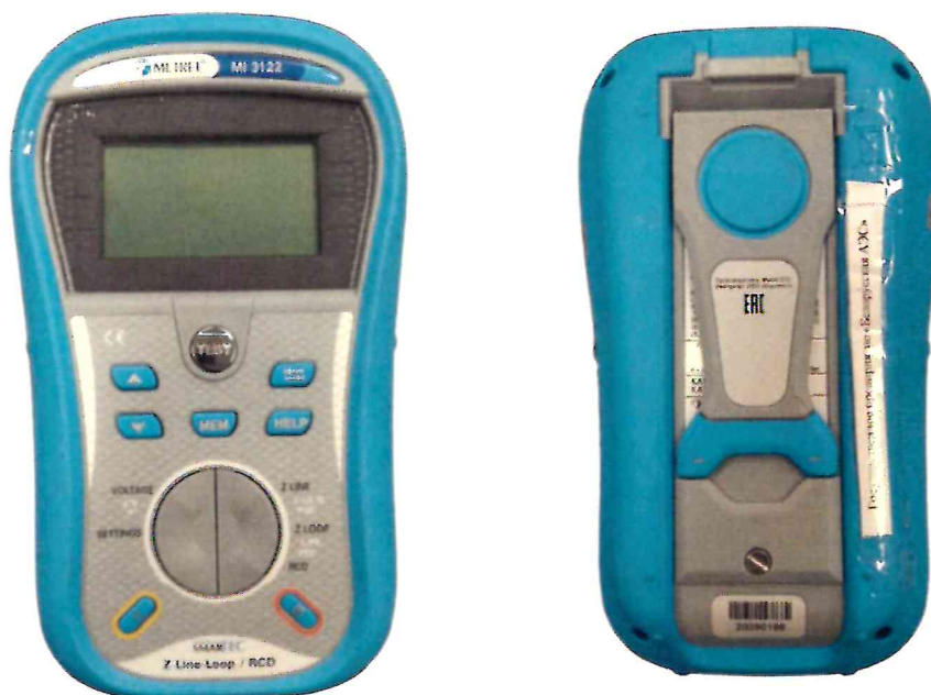
Рисунок 1.1 – Фотография общего вида измерителя полного сопротивления линии, контура и параметров УЗО MI 3122 № 20290198
